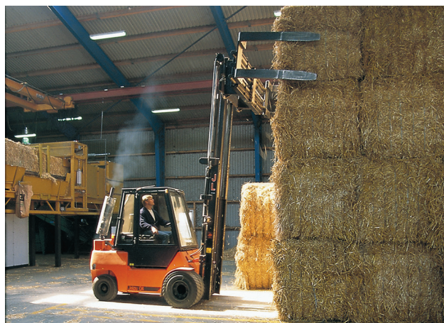
Baloturile de paie sunt așezate în depozitul tampon cu un stivuitoar. Baloturile trebuie descărcate și plasate în zona marcată cu galben, astfel încât macaraua să poată colecta automat baloturile din spațiul de depozitare. Fotografie Torben Skøtt, BioPress.
