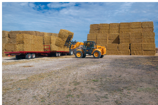
Descargando dos pacas de paja a la vez con un cargador de telescopio se reduce la carga de trabajo. FOTO Torben Skøtt, BioPress.
