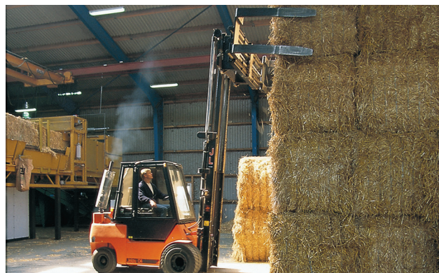
Las pacas de paja se colocan en el almacenamiento intermedio con una carretilla elevadora. Las pacas deben descargarse y colocarse dentro del área marcada en amarillo, de modo que la grúa las pueda recoger automáticamente del almacén.
