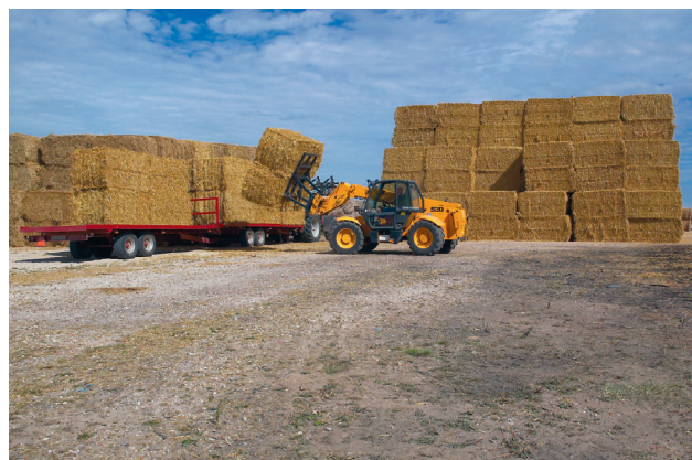
Déchargement de deux balles de paille à la fois avec un chargeur télescopique pour optimiser la manutention.
