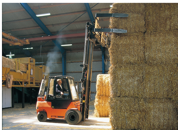
Les balles de paille sont prises par chariot élévateur équipé d'une fourche, puis placées dans la zone délimitée en jaune, pour faciliter la reprise de la grue vers le stockage.
