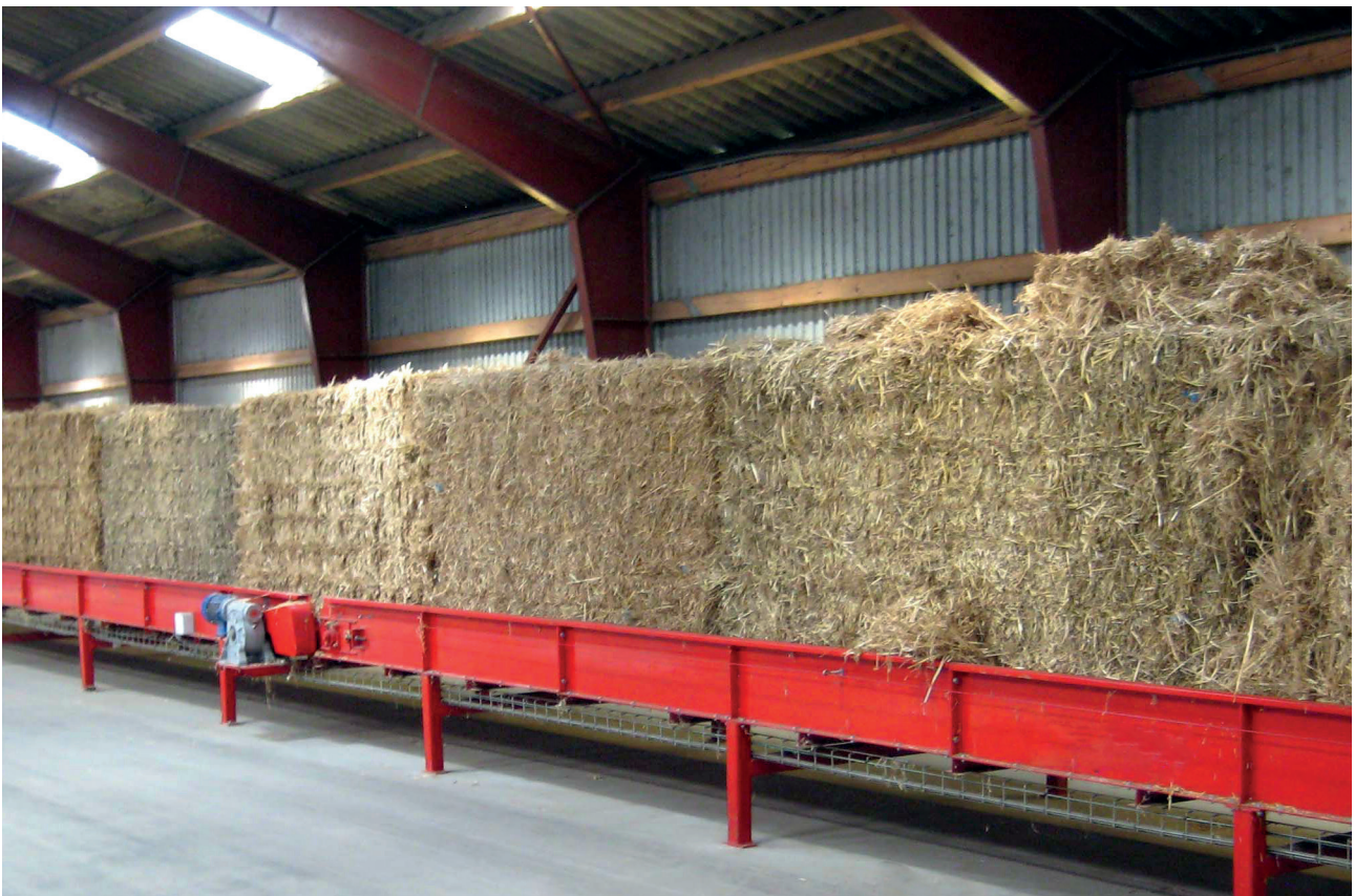
Convoyeur de balles de paille pour un chargement automatique. PHOTO Cormall A/S.
