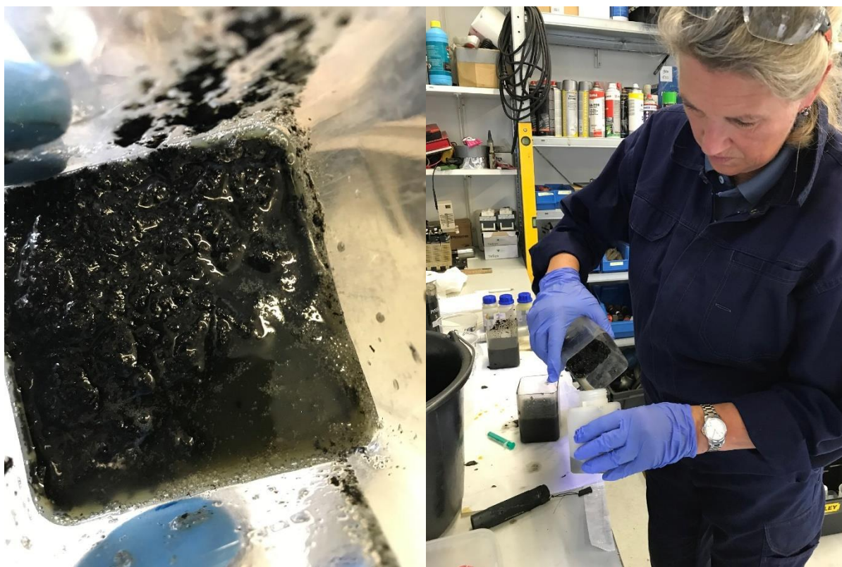
Afgasset gylle efter tilsætning af først jern(III)sulfat og dernæst polymer. Polymertilsætningen medførte en udfældning af partikler og dermed en væskefase, hvorfra der kunne udtages prøve til analyse for P-indhold.
