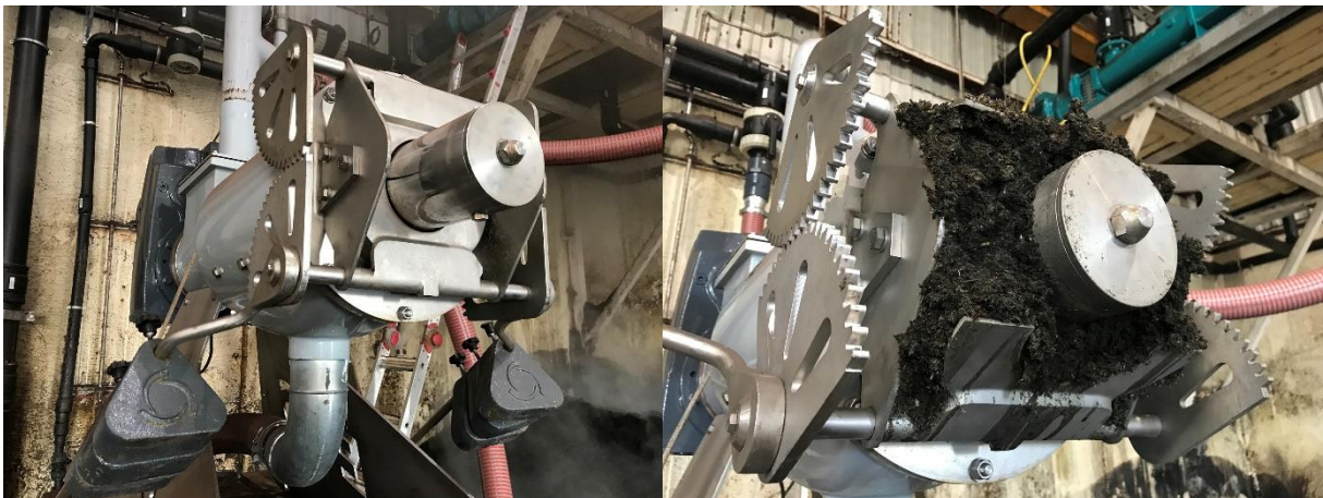
EYS skruepresse. Tilløbet af afgasset gylle sker via røret ovenpå skruepressen, mens afløbet af væskefraktionen sker via røret under skruepressen. Separationsgraden indstilles via forskydning af ballastklodserne på de to jernstænger. Nederst t.v. ses det lukkede afkast for fiberfraktionen, og t.h. ses afkastet under kørsel med skruepressen.
