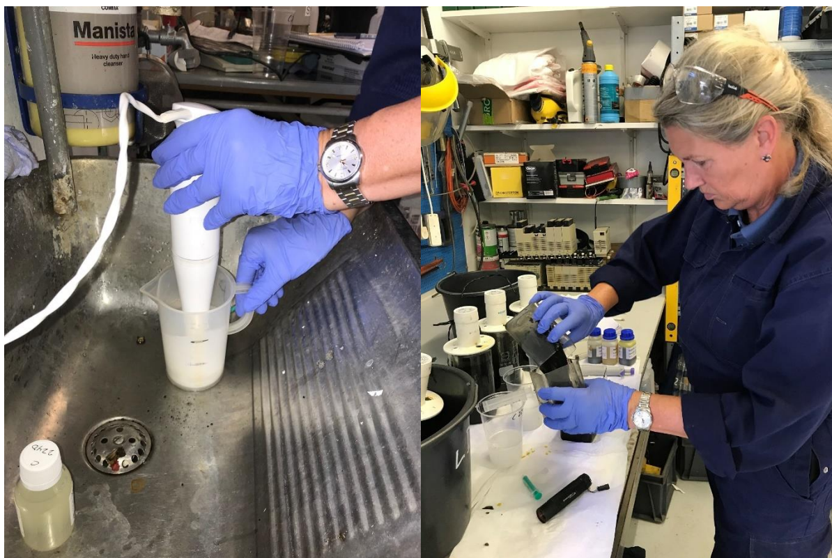
Fremstilling af polymeropløsning (t.v.) og iblanding af polymeropløsning i afgasset gylle med jern(III)sulfat (t.h.).
