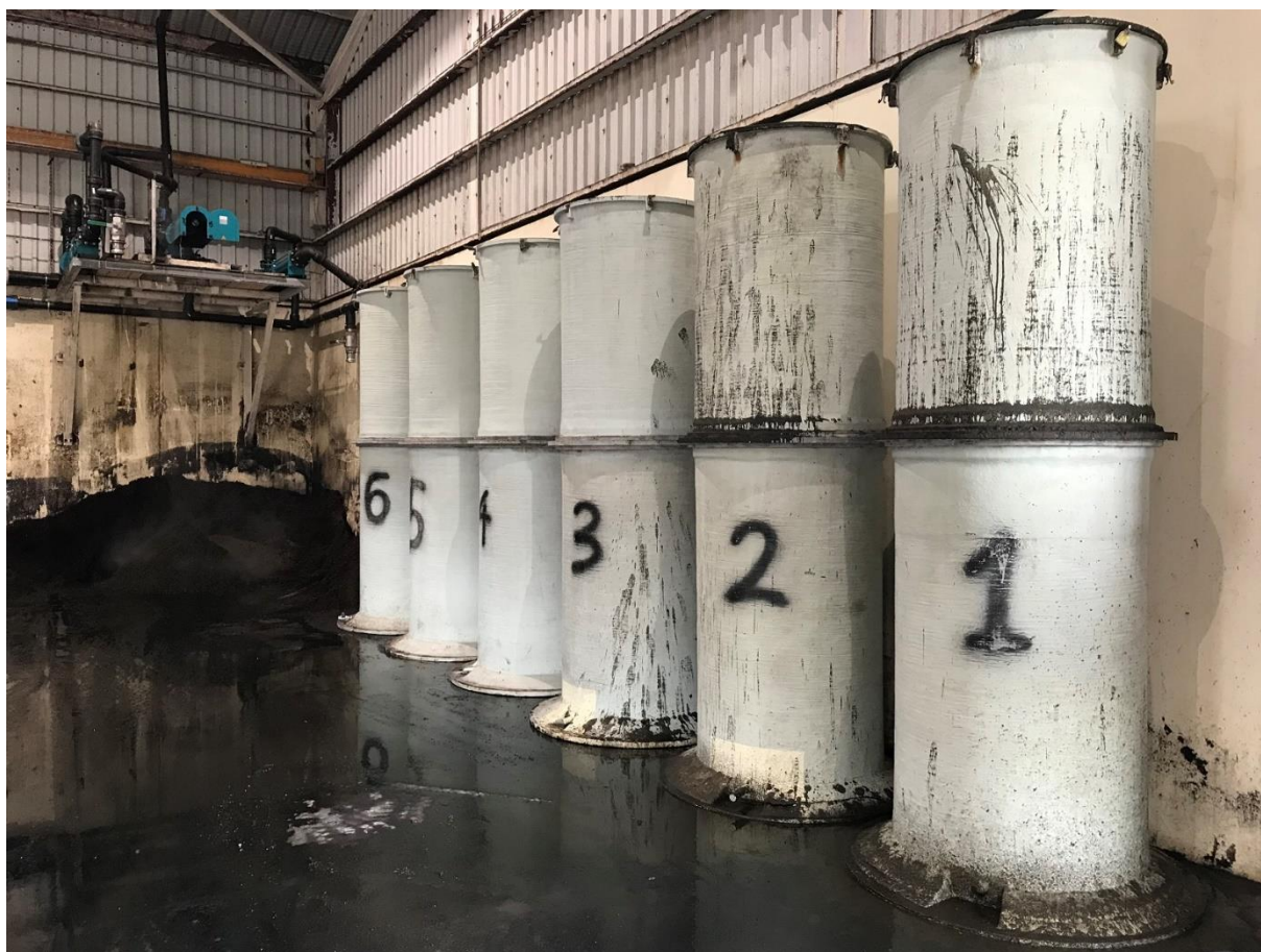
Forsøgsopstilling med sedimentationsforsøget, hvor de tre siloer til højre blev anvendt.
