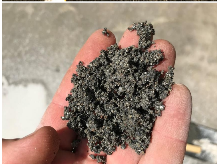
Udtagning af homogen og metalfri askefraktion fra forbrænding af gyllefiber og hønsegødning.
