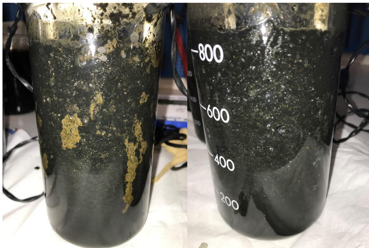
Fældning med jern(III)sulfat (t.v.) og aluminiumklorid (t.h.). Tilsætningen af de to fældningsmidler medførte en opskumning og fortykning af gyllen, men der skete ikke nogen separation i en grad, så der dannedes en væskefase til analyse for P-indhold.
