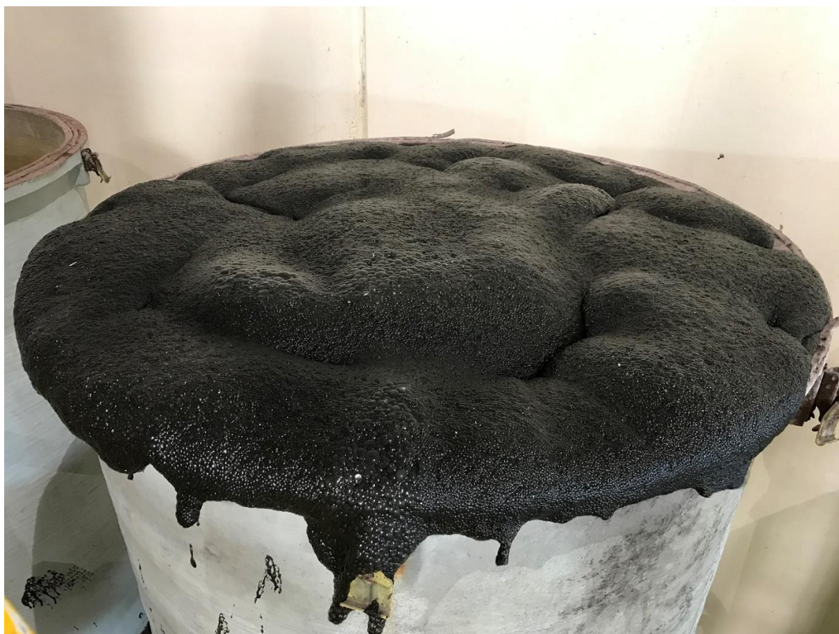
Skumdannelse efter opfyldning af forsøgssiloer, her med væskefraktion fra EYS skrue- presse ca. en time efter opfyldningen.
