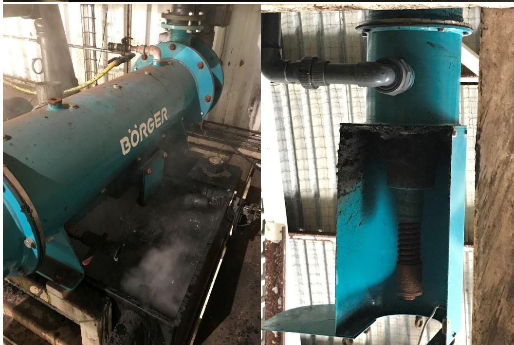
Börger skruepresse. Øverst ses afløbet for væskefraktionen, der løber ned i kar under skruepressen. Nederst t.h. ses undersiden af udkastet for fiberfraktionen.
